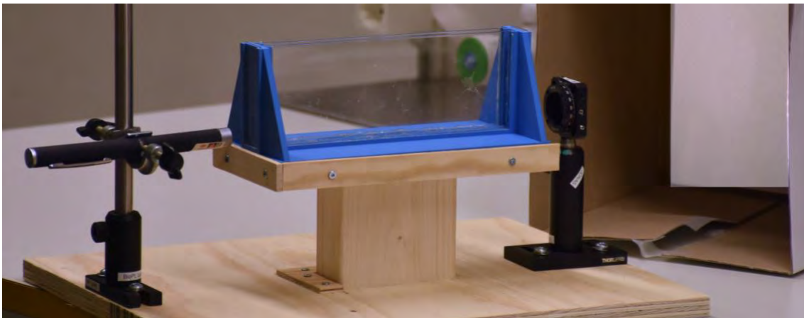
Abbildung 10. Versuchsaufbau zur Polarisationsmessung mit Laser, Messkammer, Polarisationsfilter und Box mit weißem Papier im Inneren.
